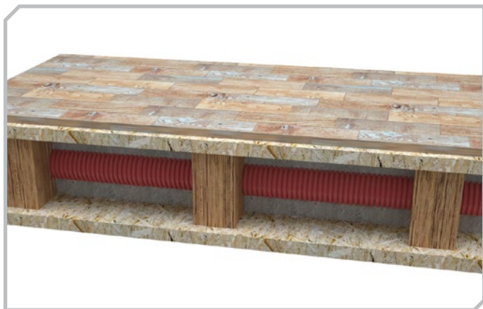
Внутри деревянных перекрытий через балки
